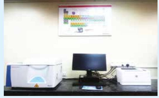
বায়ুতে বিদ্যমান বিষাক্ত ও ভারী ধাতুর গুণাগুণ নির্ণয়ে ব্যবহৃত EDXRF
